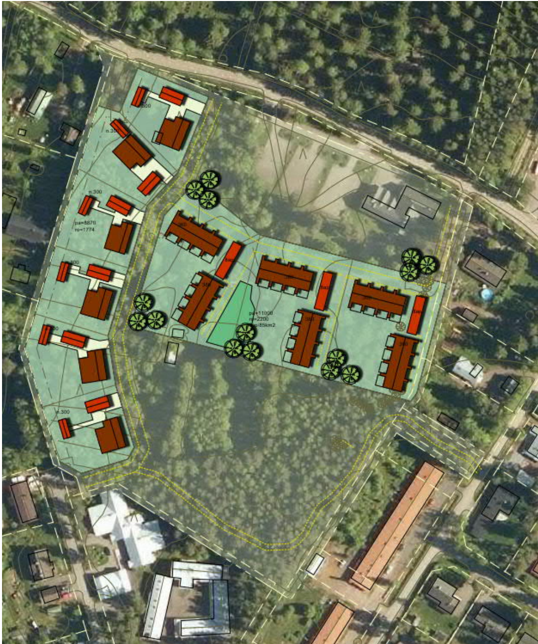
Rakennemalli VE3. Mallissa Rivitaloalue ja erillispientalojen alue muodostavat yhden kokonaisuuden. Mallissa osoitettiin molemmille osa-alueille oma pääsytie, erillispientaloalueelle Paavolantieltä pumpppaamon itäpuolelta ja rivitaloalueelle seurakuntatalon itäpuolelta. Malli voidaan toteuttaa myös ilman seurakuntatalon viereistä pääsytietä.
